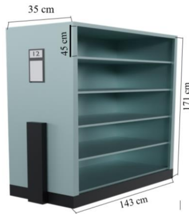
Gambar 2. Usulan Desain Ulang Rak Penyimpanan DRM
