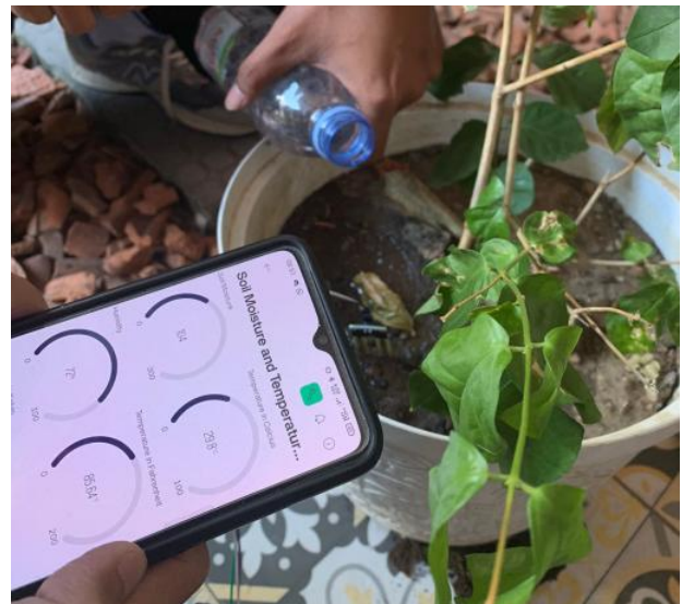
Gambar 12 Pengujian Kondisi Basah dituangkan Air 100ml
