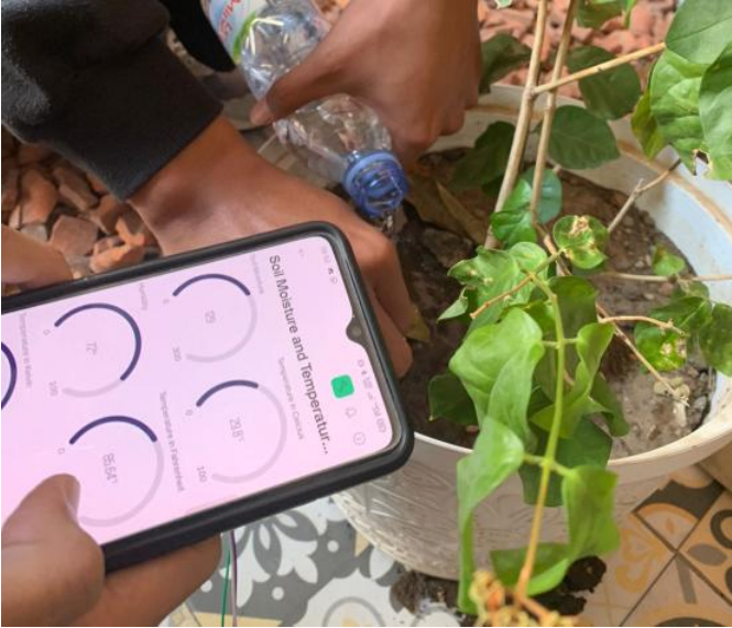
Gambar 13 Pengujian Kondisi Basah dituangkan Air 150ml
