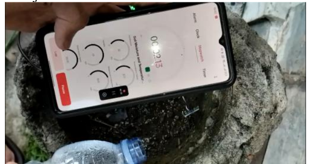
Gambar 15 Pengujian Delay saat Sensor Pertama Kali Merespon Perubahan Kelembaban Tanah
