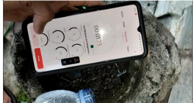
Gambar 14 Pengujian Delay saat Air Pertama Kali Menyentuh Tanah
