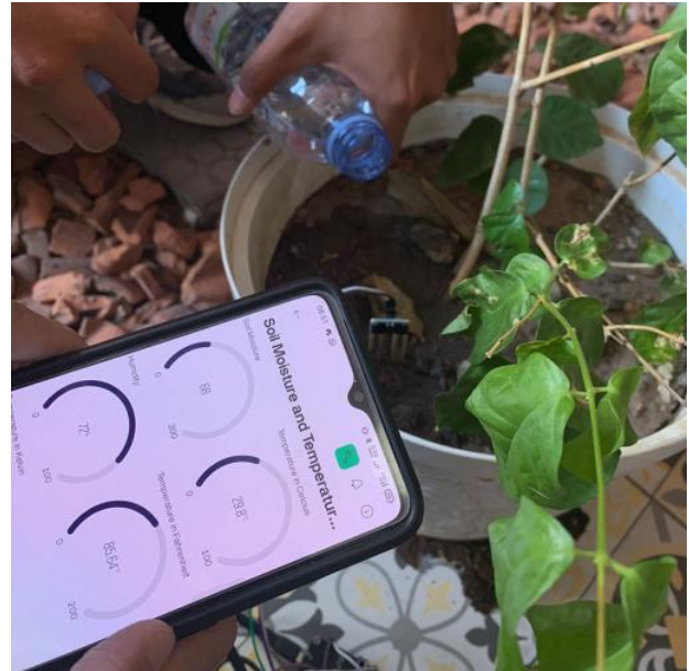
Gambar 11 Pengujian Kondisi Basah dituangkan Air 50ml
