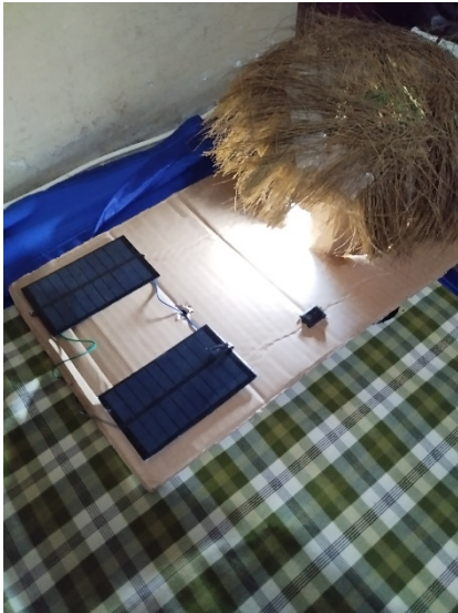
Gambar 10. Hasil Rangkaian Panel Surya dengan Rumah Honai
