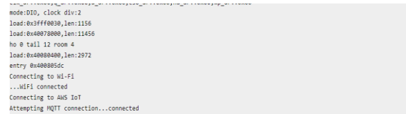
Gambar 7. ESP32 terhubung ke AWS IoT Core
