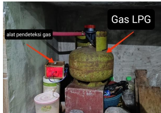
Gambar 19. Pengujian menggunakan Gas LPG
