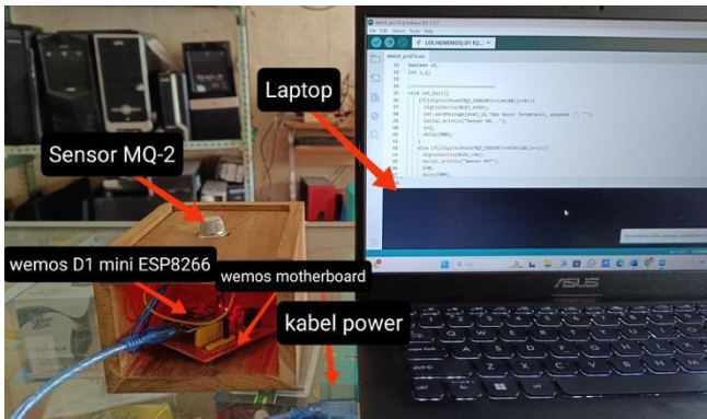
Gambar 12. Proses memasukkan program coding.
