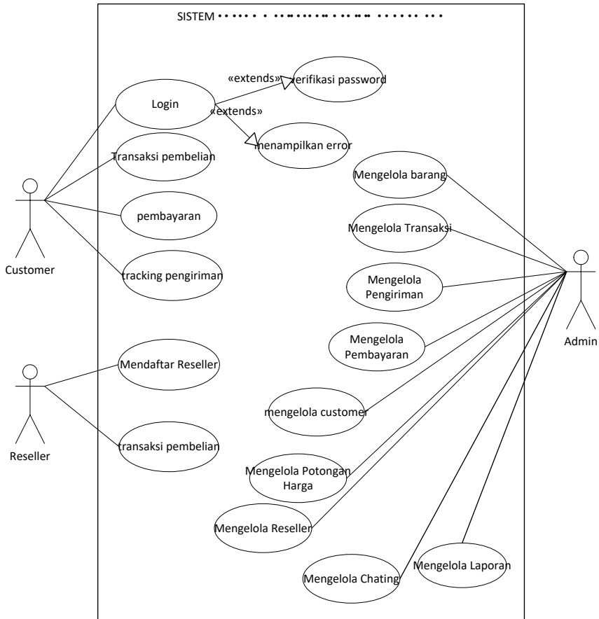
Gambar 2. Use case diagram untuk sistem CRM
