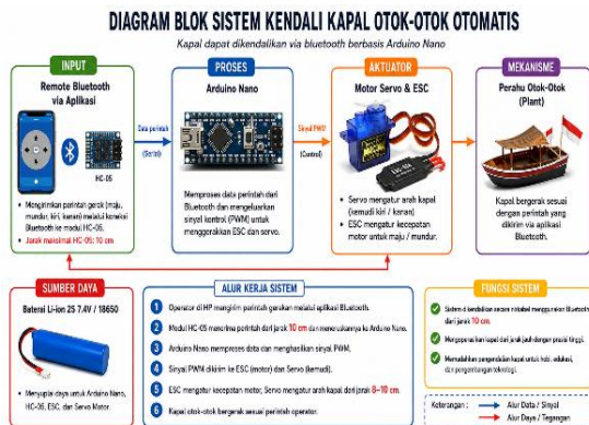
Gambar 2. Diagram Blok Kapal Otok-otok Otomatis
