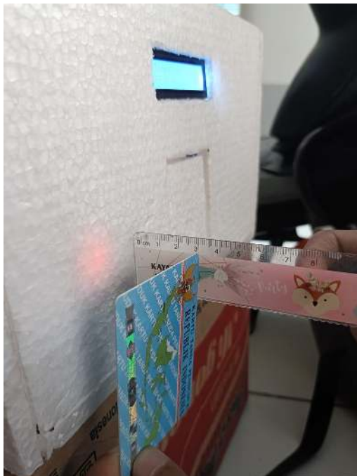
h.) Pengukuran RFID dengan jarak 4 cm
