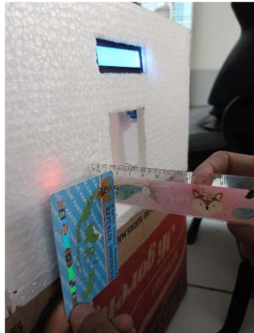
e.) pengukuran RFID dengan jarak 2.5 cm
