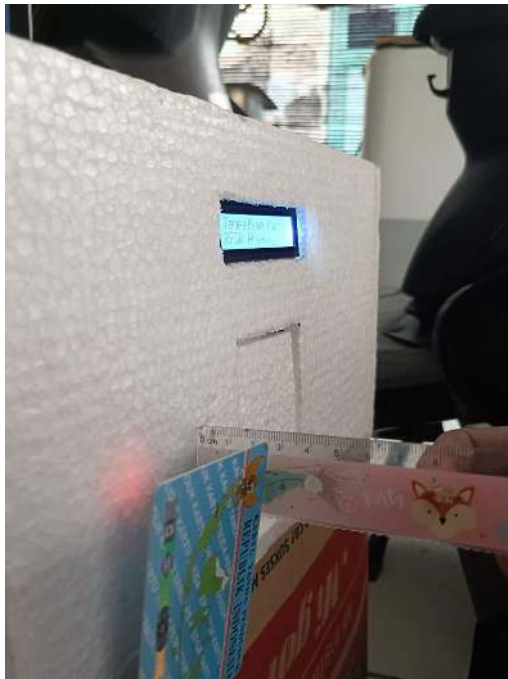
g.) Pengukuran RFID dengan jarak 3.5 cm
