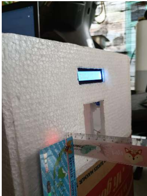
c.) pengujian RFID dengan jarak 1.5 cm
