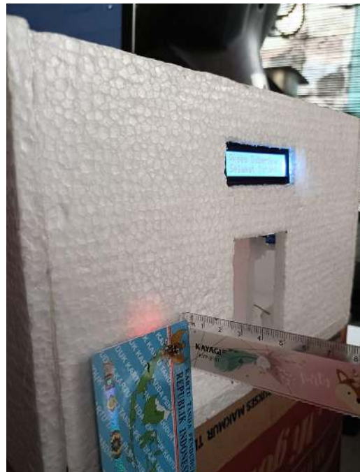
b.) Pengujian RFID dengan jarak 1 cm
