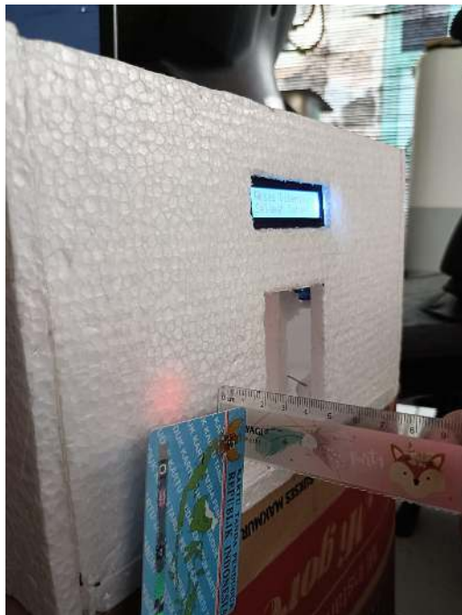
d.) pengujian RFID dengan jarak 2 cm
