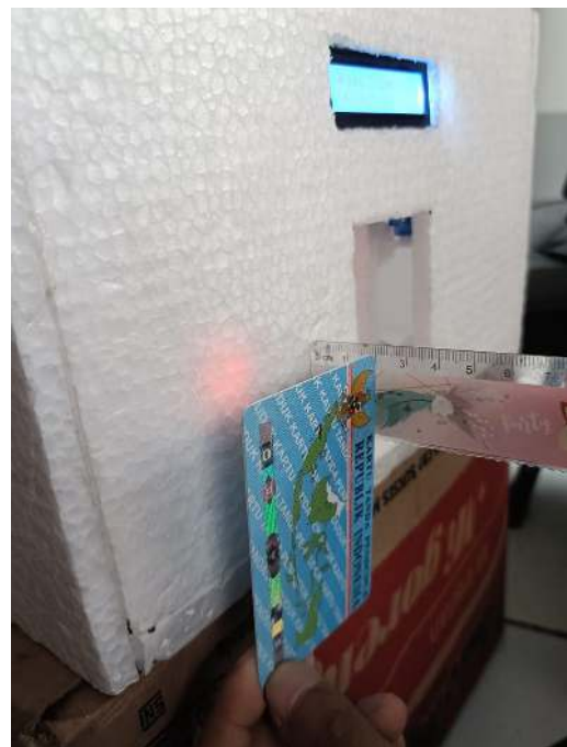
f.) Pengukuran RFID dengan jarak 3 cm
