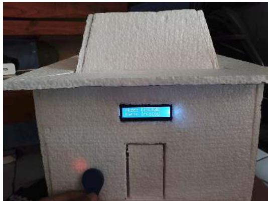
c) pengujian menggunakan gantungan kunci biru RFID
