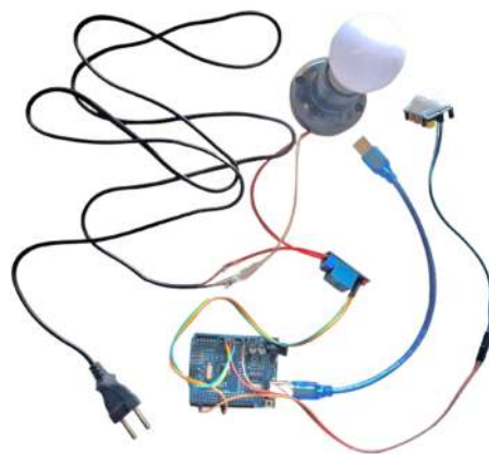
Gambar 4. Wiring diagram rangkaian sistem lampu otomatis
