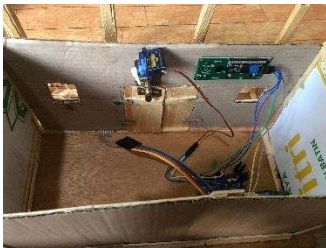
Gambar 5: Implementasi rangkaian alat pada pintu miniatur Rumah Kebaya
