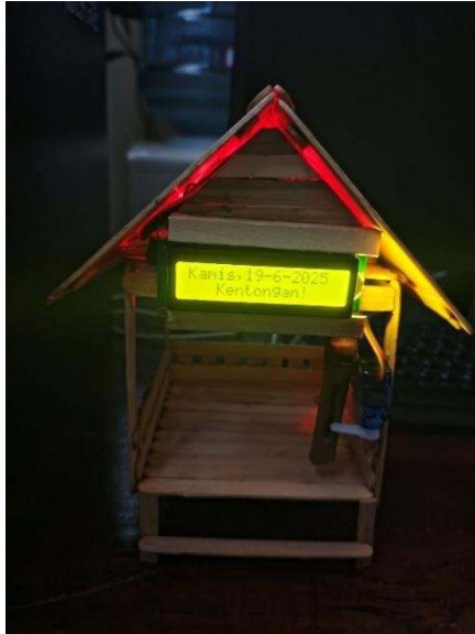
Gambar 9. Tampilan LCD menunjukkan teks "Kentongan!" dan servo aktif memukul
