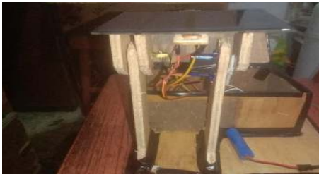
Gambar 3.5. Rancangan Pengerak Panel Surya dengan Servo SG90
