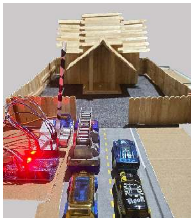
Gambar 7. palang terbuka secara otomatis saat terdapat objek dalam jarak \leq 20 .
