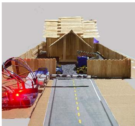
Gambar 8. Palang tertutup saat tidak ada kendaraan.
