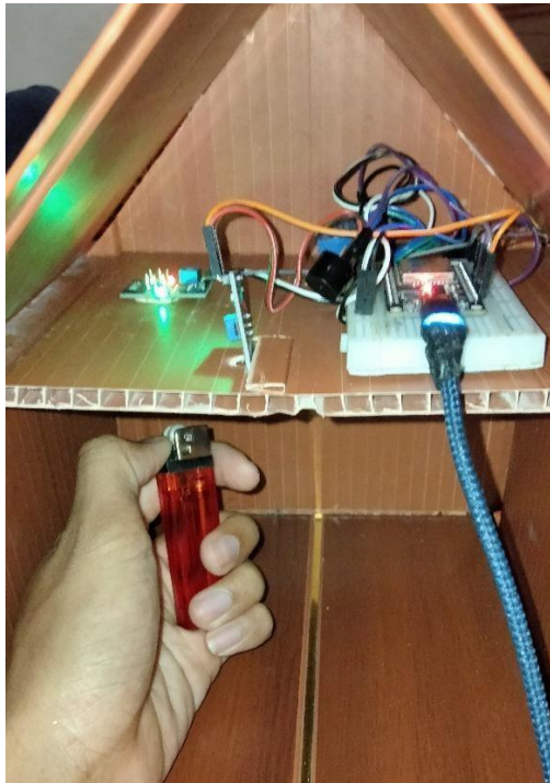
Gambar 7. Pengujian Gas Sensor
