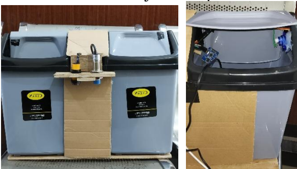
Gambar 4. Alat Pemilah Sampah Otomatis Berbasis ESP32
