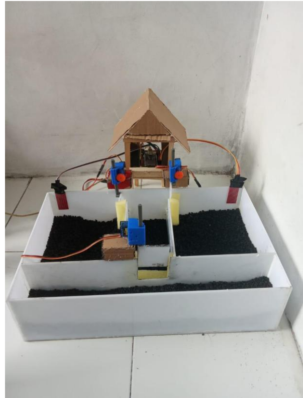
Gambar 4. Miniatur Irigasi Otomatis dengan Servo Motor dan Sensor
