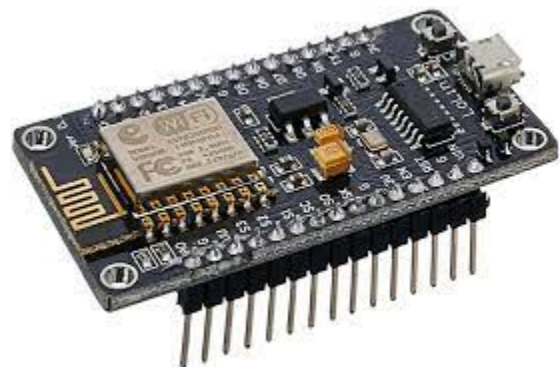
Gambar 1 Node MCU8266 Node MCU8266 adalah modul Wi-fi yang dapat ditambahkan ke mikrokontroler seperti arduino
